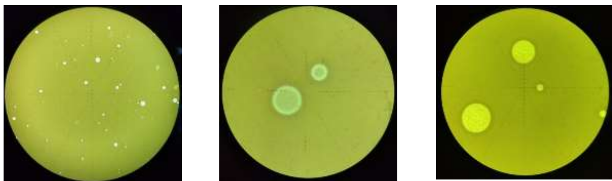
Рисунок 10. Микрофотографии латексов, полученных в условиях полупериодического режима эмульсионной сополимеризации ВА с 2-ЭГА в присутствии ПВС 17-88
